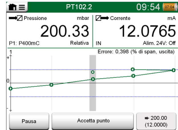
Taratura con accettazione manuale.
