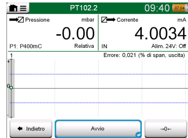
Pulsante nell'angolo inferiore destro per azzerare il modulo di pressione.
