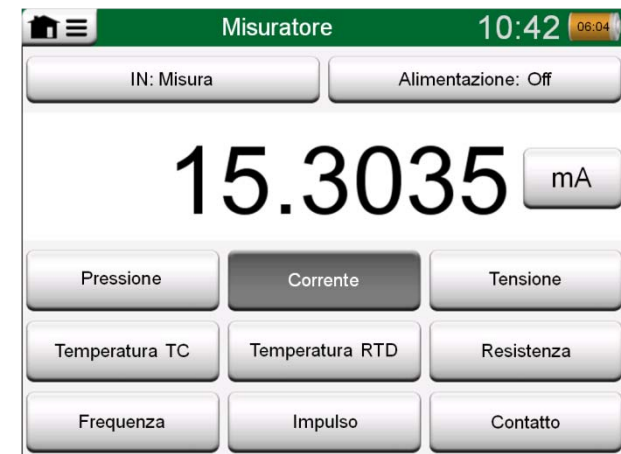
Misura di corrente utilizzando il Misuratore
