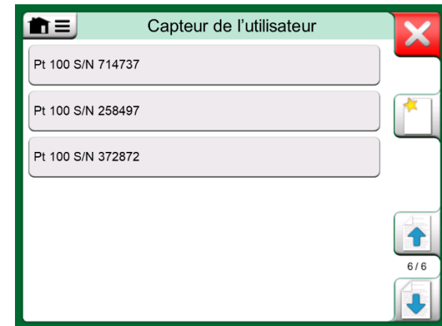
Exemple d'une liste de capteurs PRT personnalisés saisie dans MC6-Ex.
